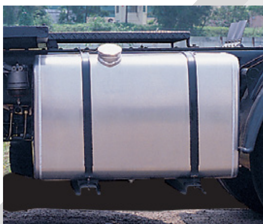
油缸以鋁合金製造，有效防止生鏽，確保持久耐用。
