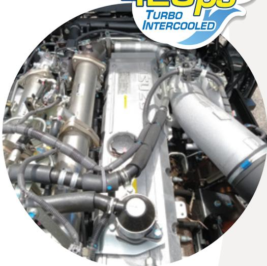
新一代CYZ52採用先進五十鈴6WG1E6N 24氣閥、VGS渦輪增壓柴油引擎，馬力輸出高達420匹，扭力最高可達190公斤-米。加上7前速超速檔鋁合金波箱，行車加倍順暢穩定。
