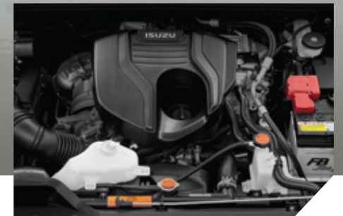
全新環保6d型 ISUZU RZ4EE6S VGS Turbo 引擎，最高馬力達163匹，扭力高達36.7公斤-米
